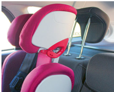
Umgekehrt montierte Kopfstütze vermeidet lose Teile im Auto und der Kindersitz liegt optimal am Fahrzeugsitz an.
