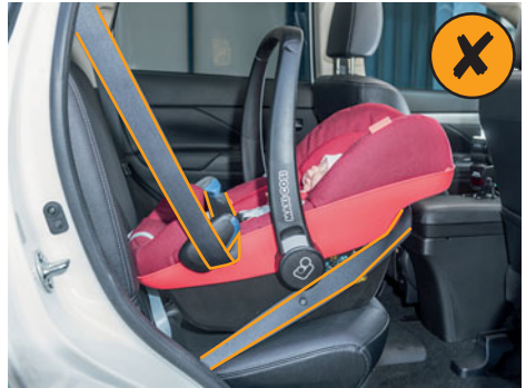
FALSCH: Falsche Gurtführung. Die Gurten können bei einem Aufprall leicht abrutschen.
