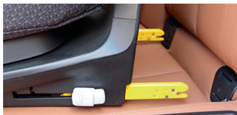
Isofix-Rasterarme in die Ösen führen und andrücken, bis die Klickfunktion greift.
