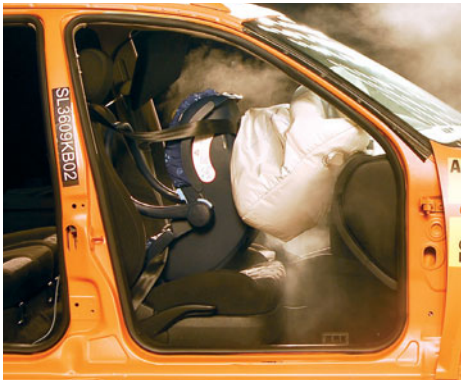
Tödliche Gefahr: Das Kind wird gegen die Sitzlehne geschleudert, wenn sich der Beifahrerairbag mit rund 250 km/h entfaltet.
