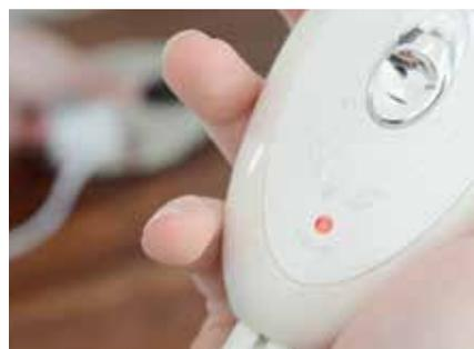
Die Ladeleuchte leuchtet auf, sobald das Gerät mit dem Netzstecker verbunden wird.
