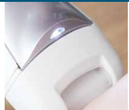
Alle getesteten Modelle haben eine LED, welche im Betrieb kurze Stoppeln sichtbar macht. Bei dem Modell von Sichler ging diese jedoch schon in der Testphase kaputt.
