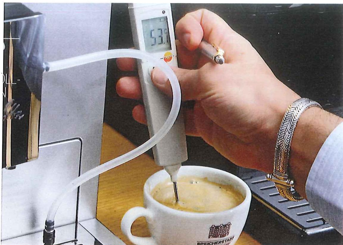
Die Tester prüften die Kaffeetemperatur direkt in den Kaffeetassen. Nach zwei Minuten ist eine Trinktemperatur zwischen 50 und 60 Grad erreicht. Außerdem relevant: die Temperatur im Bohnenbehälter. Mehr als 30 Grad sind nicht gut fürs Aroma.
