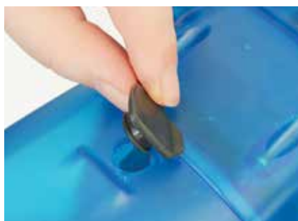
Der Ablass des (Alt-)Wasser-Tanks ist mit einem Gummielement zu verschließen.
