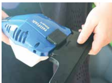
Mit einer Taste lässt sich die Düse ablösen und auswechseln.
