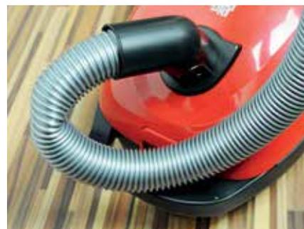
Der zu steife Schlauch knickte beim Richtungswechsel.
